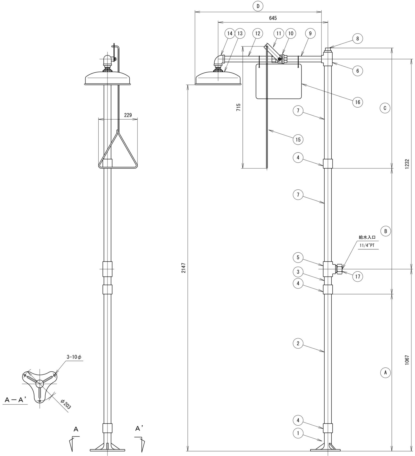
\*本ユニットに使用されるパイプ継手は、亜鉛メッキの上に、黄色の活性ポリウレタンコーティング (BRADTECT) が施されています。
